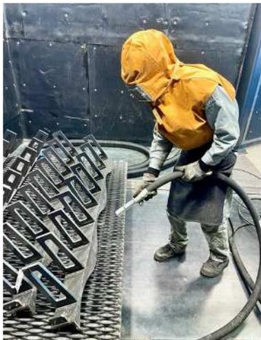
**ショットブラストを担当する藤原。**新しいものにチャレンジする技術者である。ショットブラストは小さな沢山の鉄球を被膜の対象品にあてる。この時、被膜剥がしは、適量性が求められる。あてが少ないと不要な被膜が残ったままとなる。藤原はショットブラストの鉄球の状態を理解し、どのくらいのショットが粗さが必要かを見極める。**彼は言う「鉄球が新しい時は、ブラストの角度を45度にずらし、あたる度合いを弱めるといいんです。」**まさに自由自在に鉄球を操る男である。
